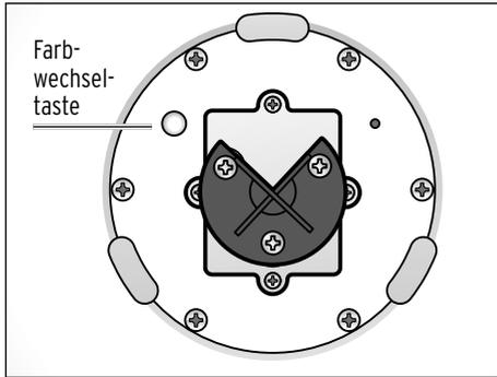
▷ Drücken Sie die Farbwechselfaste auf der Unterseite 1x, um die LEDs einzuschalten - die LEDs leuchten in wechselndem Farbenspiel.
