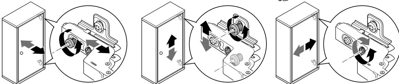
Tür ausrichten | Régler la porte | Regolare l'anta | Adjusting the door | Nastavení dvířek
