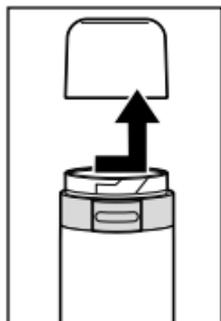
Zum gründlicheren Reinigen nehmen Sie den Scherkopf ab.
