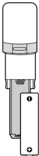
1. Ziehen Sie die Batteriefachkappe vom Gerät ab.
