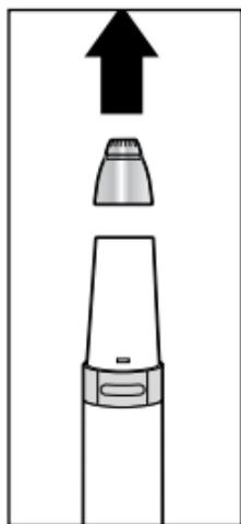
Zum gründlicheren Reinigen nehmen Sie den Schneidkopf ab.
