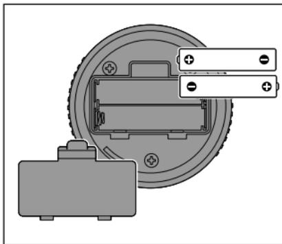
2. Drücken Sie die Lasche am Batteriefachdeckel nach unten und nehmen Sie den Batteriefachdeckel nach oben ab,
