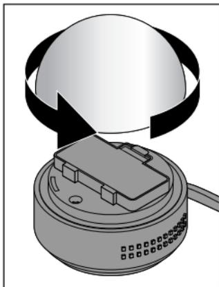
1. Drehen Sie den aufgesetzten Aufsatz gegen den Uhrzeigersinn ab.
