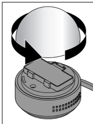
▷ Drehen Sie ggf. den aufgesetzten Aufsatz gegen den Uhrzeigersinn ab.
