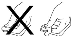
Durch Berühren der Batterie mit bloßen Händen können an den Kontakten Verunreinigungen entstehen, die u.U. isolierend wirken. Verwenden Sie daher beim Einsetzen ein trockenes, weiches Tuch.
