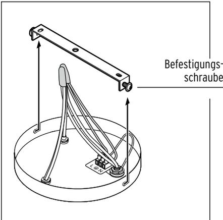
2. Lösen Sie die beiden seitlichen Befestigungsschrauben, mit denen der Deckenbügel am Leuchenträger befestigt ist, so weit, dass Sie den Deckenbügel abnehmen können.
