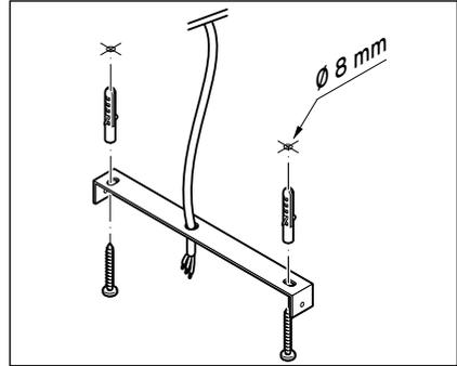
5. Führen Sie die Stromleitung (Deckenkabel) durch die Kabelführung des Leuchtenhalters. Befestigen Sie den Deckenhalter mit den Schrauben und Dübeln an der Decke.
