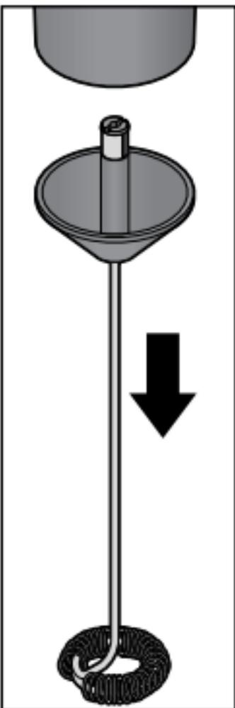
Um den Quirl in der Spülmaschine zu reinigen, ziehen Sie ihn nach unten vom Gerät ab. **Das Gerät selbst ist nicht spülmaschinen geeignet!**
