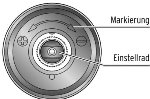
Drehen Sie am Einstellrad, um den Mahlgrad stufenlos einzustellen. Beachten Sie dabei die Markierungen auf der Unterseite der Mühle.
