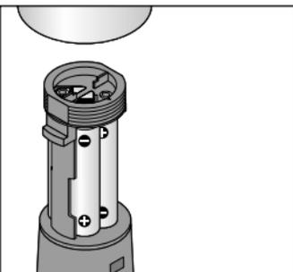
Nehmen Sie den Motor mit dem Batteriefach aus dem Gehäuse und setzen Sie die Batterien wie abgebildet ein. Achten Sie dabei auf die korrekte Polarität (+/-).
