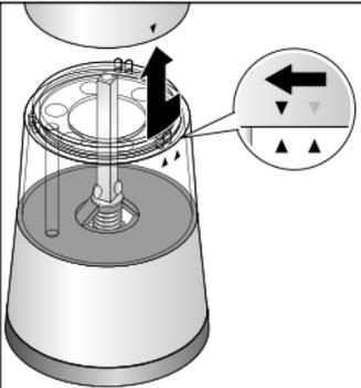
Halten Sie mit einer Hand den Gewürzbehälter fest. Drehen Sie mit der freien Hand das Gehäuse bis zum Anschlag im Uhrzeigersinn und nehmen Sie es vom Gewürzbehälter ab.
