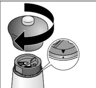
Schieben Sie den Motor wieder in das Gehäuse. Drehen Sie den Motor langsam, bis das Gewinde oben am Motor aus dem Gehäuse ragt. Die richtige Position erkennen Sie an den dreieckigen Markierungen am Gehäuse und am Gewinderand.
