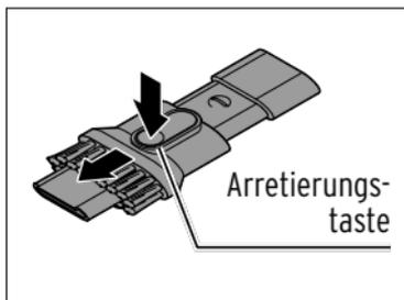
1. Drücken Sie die Arretierungstaste und schieben Sie die Bürste nach vorn.
