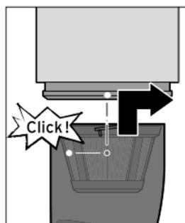
2. Setzen Sie den Staubbehälter so auf das Gehäuse, dass der Kreis am Staubbehälter auf den Punkt am Gehäuse weist (siehe Abbildung).
