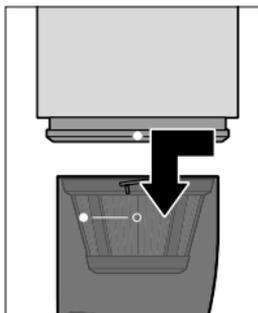
3. Drehen Sie den Staubbehälter gegen den Uhrzeigersinn, so dass der Kreis am Staubbehälter auf den Punkt am Gehäuse weist (siehe Abbildung), und nehmen Sie den Staubbehälter vom Gehäuse ab.
