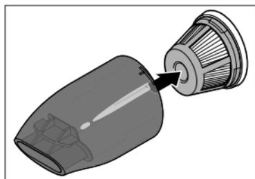
4. Ziehen Sie den Filter aus dem Staubbehälter heraus.
