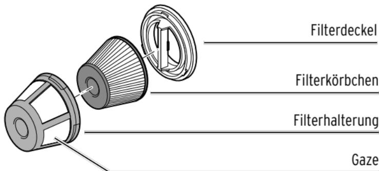
1. Drehen Sie den transparenten Filterdeckel im Uhrzeigersinn und nehmen Sie ihn zusammen mit dem Filterkorbchen aus der Filterhalterung.
