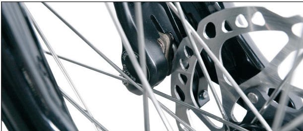
Abb. 11 Bremscheibe mittig einführen
