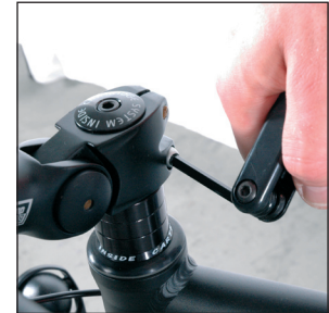
Abb. 26 Klemmschraube des Vorbaus am Gabelschaft
