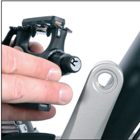
Abb. 36 Rechtes Pedal an rechten Kurbelarm montieren
