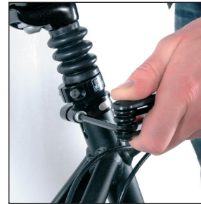
Abb. 34 Einstellung der Sattelhöhe
