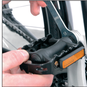
Abb. 37 Rechtes Pedal im Uhrzeigersinn festziehen
