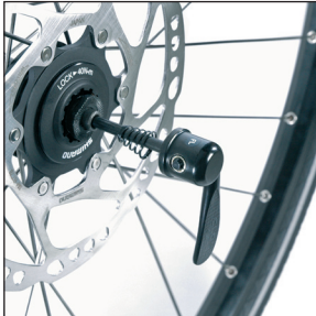
Abb. 3 Schnellspannhebel links in Fahrtrichtung montieren
