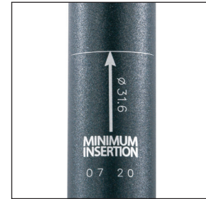
Abb. 35 Maximale Auszugshöhe beachten!
