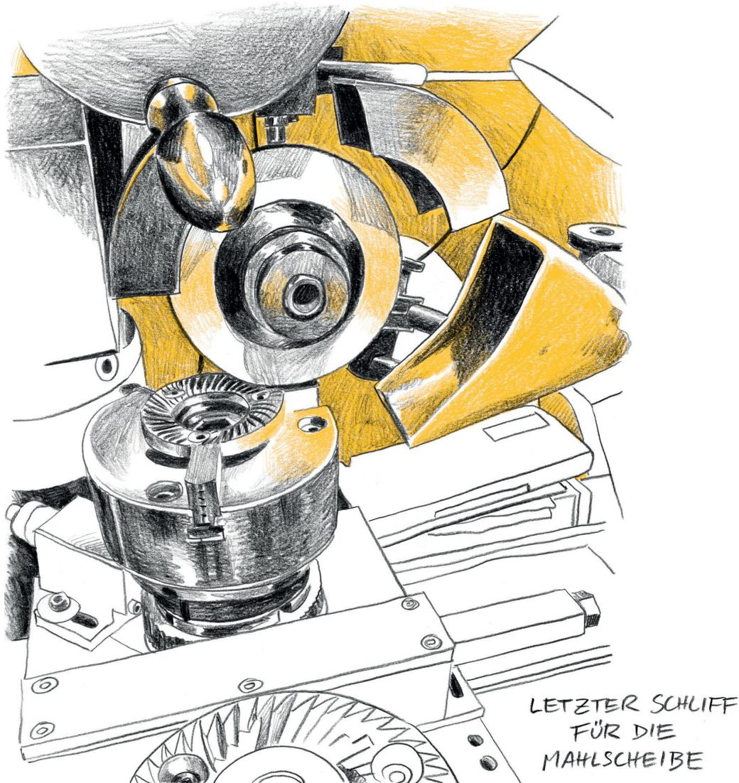
untersucht: die Mahlscheibe, von der im vergangenen Jahr 700 000 Stück gefertigt wurden. Pro Mühle braucht man zwei dieser jeweils auf einer Seite mit einem Zahnkranz versehenen Ringe aus Hartmetall, einer oben, der andere unten, dazwischen werden durch schnelle Rotation die Bohnen zermalmt, der verstellbare Spalt zwischen den Scheiben bestimmt den Mahlgrad.
