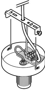
1. Schieben Sie den Leuchenträger auf die beiden leicht eingedrehten Befestigungsschrauben des Deckenbügels auf.
