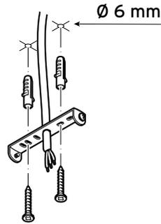
6. Führen Sie die Stromleitungen (Deckenkabel) durch die Kabelführung des Deckenbügels. Befestigen Sie den Deckenbügel mit den Schrauben und Dübeln an der Decke.
