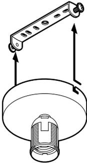
3. Lösen Sie die beiden seitlichen Befestigungsschrauben, mit denen der Deckenbügel am Leuchenträger befestigt ist, so weit, dass Sie den Deckenbügel abnehmen können.
