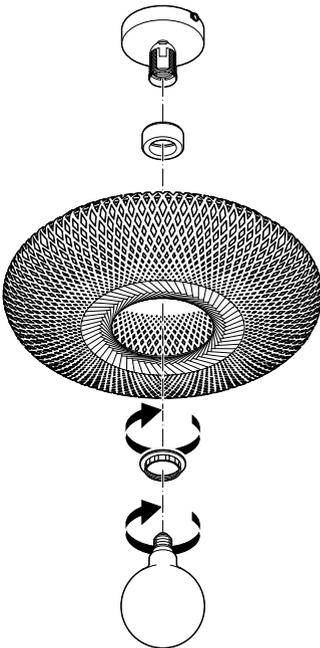
3. Schieben Sie den Distanzhalter und den Lampenschirm über die Fassung und drehen Sie den Fassungsring auf und das Leuchtmittel in die Fassung.
