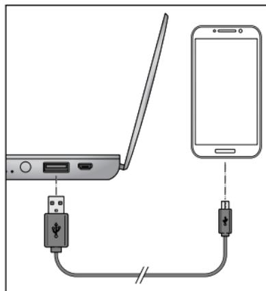
▷ Schließen Sie die Powerbank wie abgebildet mit dem mitgelieferten USB-Ladekabel an das Gerät an, das Sie laden möchten.
