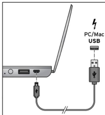
1. Schließen Sie die Powerbank wie abgebildet mit dem mitgelieferten USB-Ladekabel an einen USB-Anschluss Ihres Computers oder eines Netzadapters
