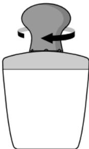
5. Drehen Sie den Drehknopf solange im Uhrzeigersinn, bis sich das Eis aus der Form löst.
