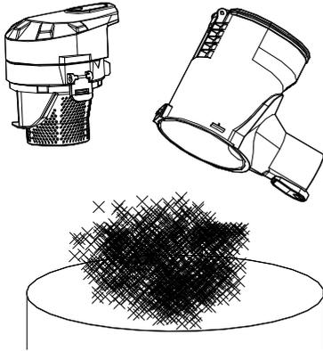
6. Leeren Sie den Reststaub aus dem Auffangbehälter.
