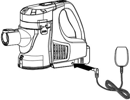
1. Stecken Sie den Stecker des Netzadapters in die Anschlussbuchse auf der Seite des Akkusaugers.
