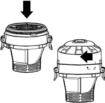
2. Setzen Sie den Deckel auf den Filtereinsatz - das kleine Dreieck zeigt auf **OPEN** - und drehen Sie den Deckel in Pfeilrichtung, bis das Dreieck auf **CLOSE** zeigt. Der Deckel rastet hör- und spürbar ein.
