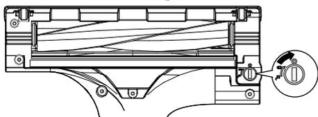
7. Drehen Sie den Sperrknopf wie abgebildet etwas im Uhrzeigersinn in die ursprüngliche Position.
