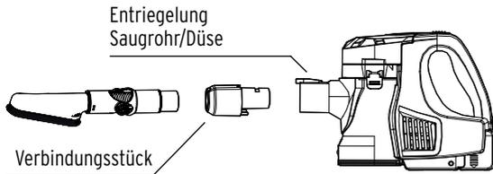
**Anschluss Polsterbürste direkt an den Akkusaugerkopf**
