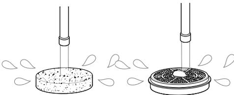
3. Spülen Sie den Schwamm und den Filterhalter unter fließend warmem Wasser aus.
