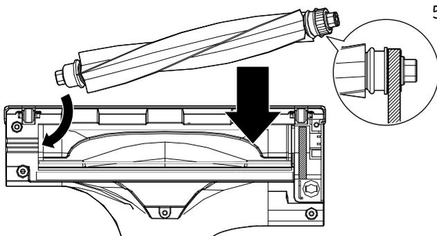
5. Setzen Sie die Bürstenwalze zuerst an der linken Seite ein. Legen Sie den Antriebsriemen über das Zahnrad und drücken Sie die Bürstenwalze dann auf der rechten Seite in die Aussparung. Die Bürstenwalze muss hör- und spürbar einrasten.
