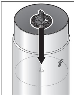
2. Stecken Sie den Rührersatz wie abgebildet (mit dem Griff nach oben) auf den Stützen im Inneren des Milchaufschäumers.
