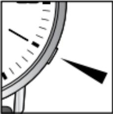
Drücken Sie für ca. 5 Sekunden die versenkte Einstelltaste mit einem spitzen Gegenstand (z.B. einem kleinen Schraubenzieher), bis der Sekundenzeiger in der kleine Anzeige zuerst bis zur 3 oder 9 läuft, kurz stehen bleibt und dann zur aktuellen Stunde (24h-Format) weiter läuft.
