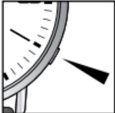
Drücken Sie für mehrere Sekunden die versenkte Einstelltaste mit einem spitzen Gegenstand, z.B. einem kleinen Schraubenzieher, **bis sich alle 3 Zeiger bewegen.**
