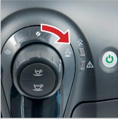
**3** Den Steuerknopf auf "☁️" drehen. Die LED "🔌" blinkt in langen Intervallen.
