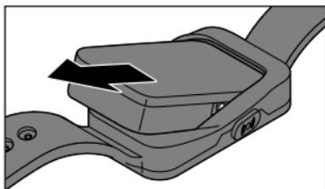
1. Drücken Sie das Alarm-Gehäuse aus dem Armband heraus.
