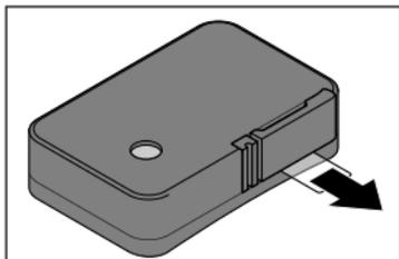
2. Ziehen Sie den Isolierstreifen aus dem Batteriefach heraus.
