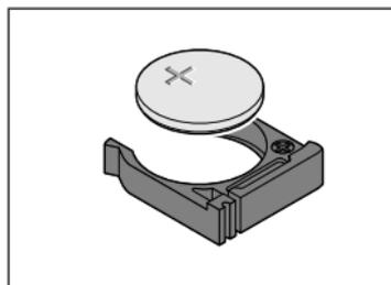
3. Legen Sie die Batterie wie abgebildet in die Batteriehalterung ein. Der Pluspol (+) muss dabei nach oben zeigen.
