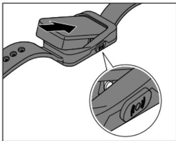
3. Setzen Sie das Alarm-Gehäuse wieder so in das Armband ein, dass der weiße Schalter hinter der Alarm-Taste am Armband liegt.
