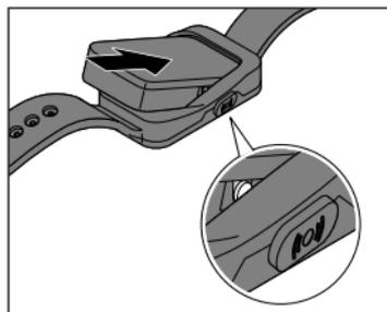
5. Setzen Sie das Alarm-Gehäuse wieder so in das Armband ein, dass der weiße Schalter hinter der Alarm-Taste am Armband liegt.
