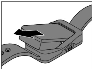
1. Drücken Sie das Alarm-Gehäuse aus dem Armband heraus.
