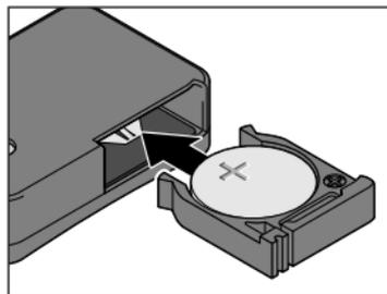
4. Schieben Sie die Batteriehalterung wieder bis zum Anschlag in das Gehäuse.
