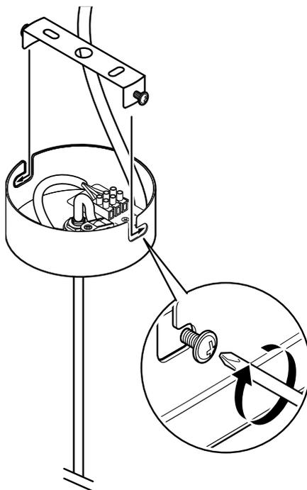
2. Engagez le cache-fils sur les deux vis de serrage de l'étrier de fixation, légèrement vissées.
