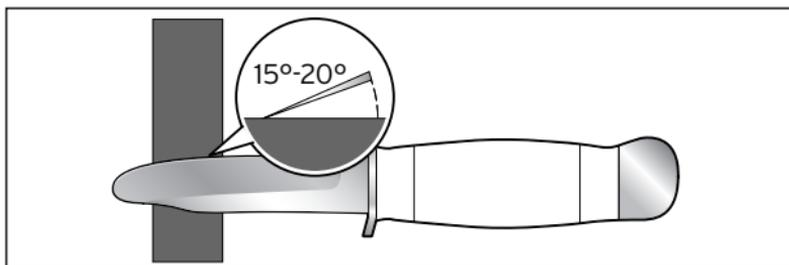
Setzen Sie das Messer in einem Winkel von 15° - 20° wie abgebildet mit der Klinge auf den Schleifstein.
