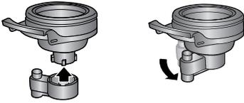
Zum Zusammensetzen stecken Sie das Unterteil auf. **Es lässt sich nur in der abgebildeten Position aufstecken!** Drehen Sie das Unterteil dann in Pfeilrichtung.
