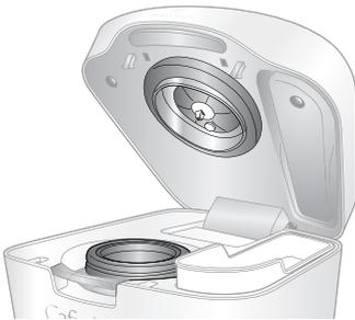
Fassen Sie die Kapsel und den dunkel dargestellten Bereich direkt nach dem Gebrauch nicht an. Die Teile sind heiß. Fassen Sie den Kapselhalter nur vorne am Griff an.
