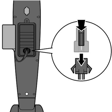
4. Drücken Sie die Rastnase oben an der Buchse des Akku-Packs an, sodass sie sich unten hebt, und ziehen Sie den Stecker ab.
