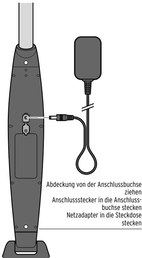
Abdeckung von der Anschlussbuchse
