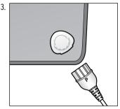
Stecken Sie den Anschlussstecker der Bedieneinheit wie abgebildet in die Anschlussbuchse am Heizkissen. Der Stecker passt nur in der abgebildeten Position in die Buchse.
