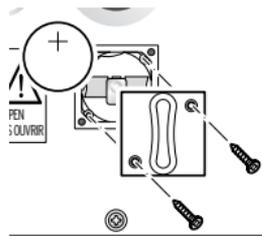
1. Lösen Sie die Schrauben und nehmen Sie den Batteriefachdeckel ab.
