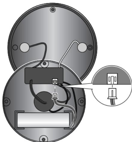
4. Das Elektronikgehäuse ist über Kabel mit dem Solar-
