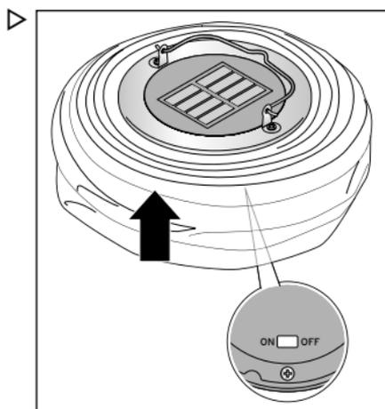
Der Leuchtenkopf sitzt nur locker oben im Lampenschirm. Halten Sie beides gut fest, wenn Sie die Leuchte aktivieren oder deaktivieren. Schieben Sie den Ein-/Aus-Schalter auf der Unterseite des Leuchtenkopfes auf **ON**, um die Leuchte zu aktivieren.
