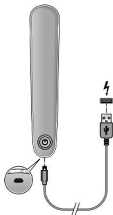
1. Stecken Sie den Mikro-USB-Stecker des USB-Ladekabels in die Anschlussbuchse unten am Gerät.
