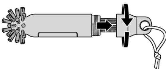
Drehen Sie die Abdeckkappe vom Griffende ab und ziehen Sie die Rohrreinigungsbürste heraus.
