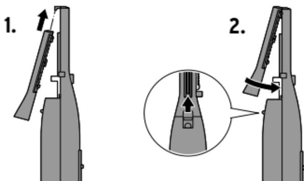
Wenn der Schneidkopf in Schritt **2** nicht von selbst in dem weißen Führungshaken einrastet, schalten Sie das Gerät kurz ein und wieder aus. Schieben Sie zum Schluss unbedingt die kleine Taste nach oben, um den Schneidkopf zu verriegeln.
