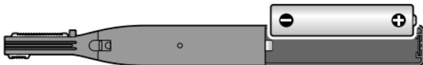
3. Setzen Sie die beiliegende Batterie ein wie im Batteriefach abgebildet. Achten Sie dabei auf die korrekte Polarität (+/-).
