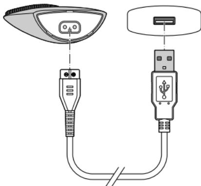
Stecken Sie den Anschlussstecker in die Anschlussbuchse am Gerät und den USB-Stecker in die Anschlussbuchse am Netzadapter.
