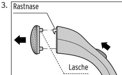
Setzen Sie den Aufsatz auf die Aufsatz-Aufnahme und drücken ihn an, bis er hör- und spürbar einrastet.
