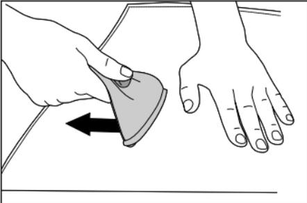
Setzen Sie eine Hand auf die Textilie, um sie zu spannen, und führen Sie den Kamm-Aufsatz mehrmals leicht und mit sanftem Druck von Ihrer Hand weg über die zu behandelnde Stelle der Textilie.
