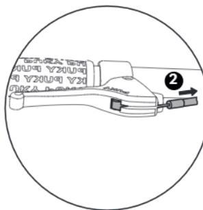
2. Træk derefter forsigtigt i det udvendige bremsekab- bel så endeanslaget går i indgreb på bremsehåndta- gets indstillingsskru.
