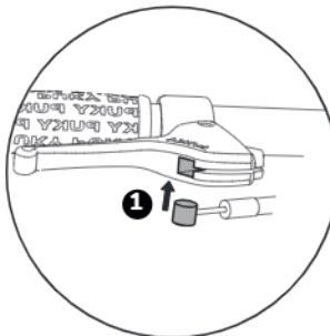
1. Vezměte volný konec brzdrovýho lanka a jeho ukončení zasuňte do příslušného prohloubení na rukojeti brzdy.
