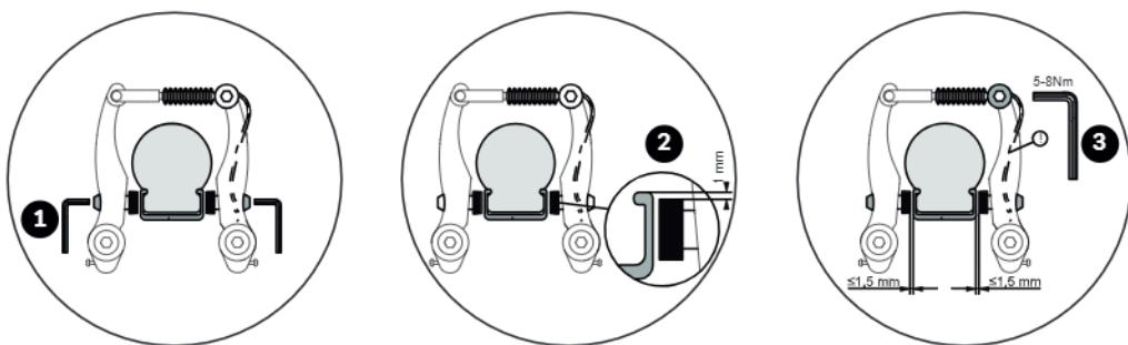
1. Draai de bevestigingsmoer van het remblokje los met een kruiskopschroevendraaier van 5 mm) en vervang het remblokje.
