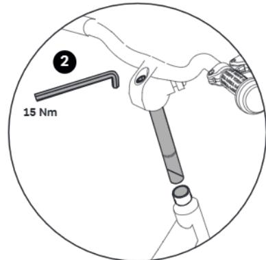
Řídit se přitom značkou minimální hloubky zasunutí na sloupu přední části. Nyní opět připevněte čalounění k řídítkům.
