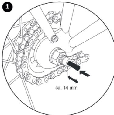
1. prelevare il perno di comando dal sacchetto di polietilene e inserirlo fino all'arresto utilizzando la penna nera, prima sul lato destro (in direzione di marcia) dell'asse posteriore.
