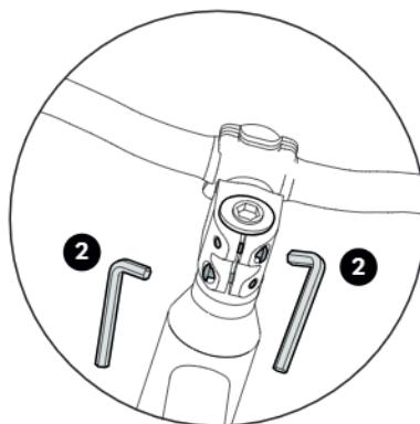
Par de apriete para la sujeción de la potencia en el tubo del vástago de la horquilla: 5-6 Nm. Asegúrese de que la potencia está firme en el vástago de la horquilla y protegida contra torsión.
