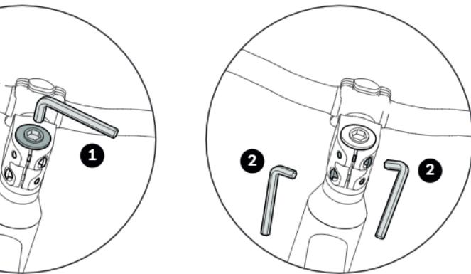
2. Regolazione corretta: il manubrio deve girarsi con facilità, senza alcun gioco del cuscinetto. Riserrare ora le viti di bloccaggio dello stelo della forcella dell'avancorpo con la coppia giusta.
