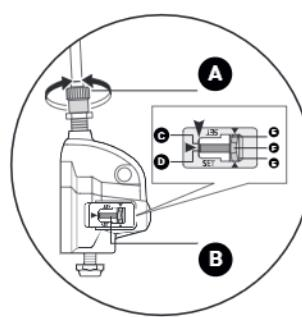
Во время установки проверьте обе желтые линии сверху через окошко. Поверните кривошипную рукоятку и переключите рычаг REVOSHIFT с положения 3 в положение 1, а затем обратно в положение 3. Повторите эту процедуру два или три раза и проверьте, меняются ли передачи. Переключите рычаг REVOSHIFT с положения 1 в положение 2 и
