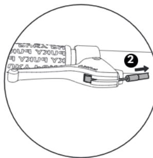
2. Trek vervolgens voorzichtig aan de buitenmantel van de remkabel om de eindaaanslag op de instelschroef van de remgreep te laten aansluiten
