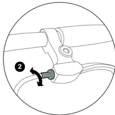
2. Trækspændingen kan indstilles ved hjælp af fingereskruen på bremsehåndtaget. Bremsen er korrekt indstillet, når bremsebelægningerne har en afstand på ca. 1,5 mm til fælgen.
