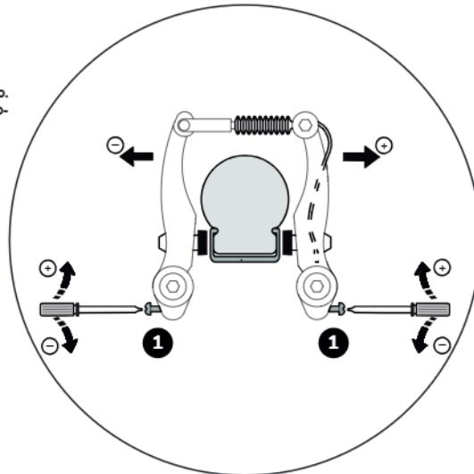
1. Pokręcając śrubą regulacyjną ramiona hamulcowe ustawić centralnie. Odstęp pomiędzy okładziną hamulcową i obręczą koła musi być identyczny z prawej i lewej strony; podczas hamowania styk okładziny hamulcowej z obręczą koła powinien być jednoczesny z lewej i z prawej strony.
