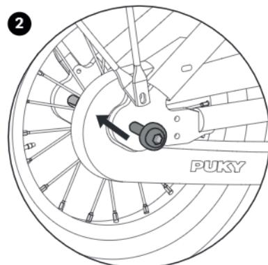
2. Napnuti řetězu lze nyní nastavit posunutím zadního kola v upevnění pastorku. Potom kolové matici opět utáhněte (utahovací moment 10 Nm)
