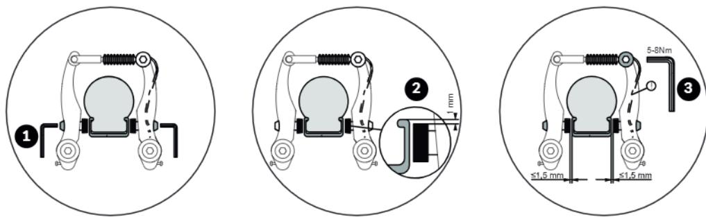
1. Suelte la tuerca de sujeción de la zapata con ayuda de una llave Allen de 5 mm y reemplace las zapatas.
