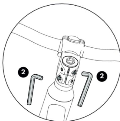
1. После переналадки проставочных колец снова смонтируйте колпачок Ahead, установите руль по направлению движения прямо и правильно отрегулируйте люфт подшипника руля. Используйте для этого регулировочный винт в колпачке Ahead.
