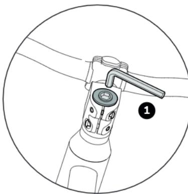
1. Nach Umbau der Spacer montieren Sie die Ahead-Kappe wieder, richten den Lenker in Fahrtrichtung gerade aus und stellen das Spiel des Steuerlagers korrekt ein. Benutzen Sie dazu die Einstellschraube in der Ahead-Kappe.
