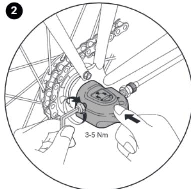
2. A continuación puede colocar la caja de cambio en el eje trasero y apretarla con la llave Allen de 5 mm (3-5 Nm). No son necesarios más ajustes en la caja de cambio.
