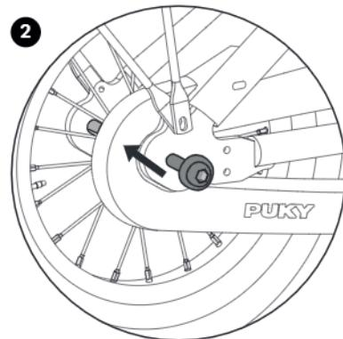
ramy. Następnie ponownie dokręcić nakrętki tylnego koła (momentem 10 Nm)
