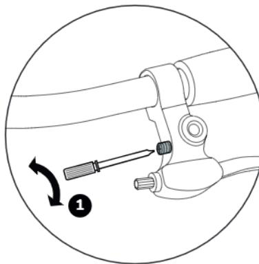
1. Grebsafstanden (afstand bremsehåndtag - styr) kan indstilles ved hjælp af en skruv på bremsehåndtaget. Vær opmærksom på, at bremsen skal gribe, inden bremsehåndtaget berører styret!
