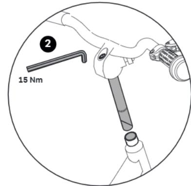
Vær i den forbindelse opmærksom på markeringen for minimumsindstiksdybden på frempinden. Anbring nu igen styrpolstringen på styret.
