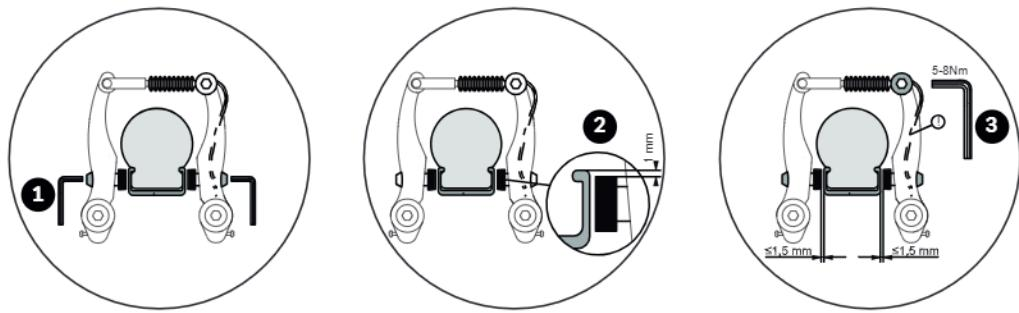
1. Отвинтите крепежную гайку тормозной накладки при помощи торцового шестигранного ключа на 5 мм и замените тормозные накладки.
