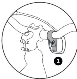
1. Para montar en el manillar debe colocar el soporte suelto sobre el manillar. Alinee el soporte y atornille el reflector frontal (blanco) con el soporte.
