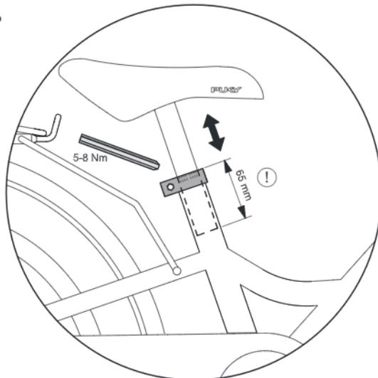
Nastavení výšky sedla: po povolení sedlové svorky pomocí 5 mm inbusového klíče se dá sedlo vytáhnout. Výšku sedla nastavte tak, aby se země dotykaly minimálně spíky, nejlépe však celá bříška chodidel, aby se dosáhl rovnovážný stav.
