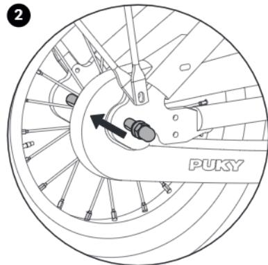
2. Die Kettenspannung kann nun durch Verschieben des Hinterrades im Ausfallende justiert werden. Danach ziehen Sie die Radmuttern wieder fest (Drehmoment 15 Nm)
