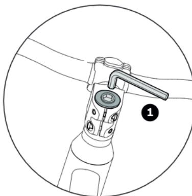
1. Tras cambiar la posición de los espaciadores, monte de nuevo la tapa Ahead, alinee el manillar recto en la dirección de marcha y ajuste correctamente el juego del rodamiento. Use para ello el tornillo de ajuste en la tapa Ahead.
