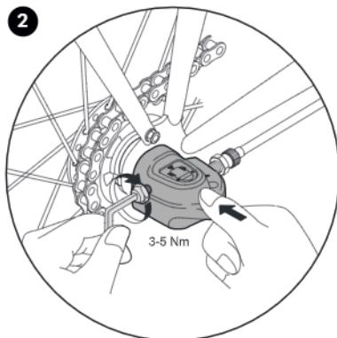
2. Poté můžete na zadní nápravu nasadit spinaci skřínku a dotáhnout ji 5 mm inbusovým klíčem (3-5 Nm). Další nastavení spinaci skřínky nejsou zapotřebí.
