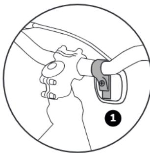
1. Для установки на руль крепление следует свободно надеть на руль. Выровняйте крепление и привинтите передний отражатель (белый) к креплению.
