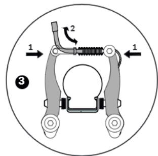
1. Tire del extremo del cable del freno e introduzca el herrete en la muesca en el asa del freno.
