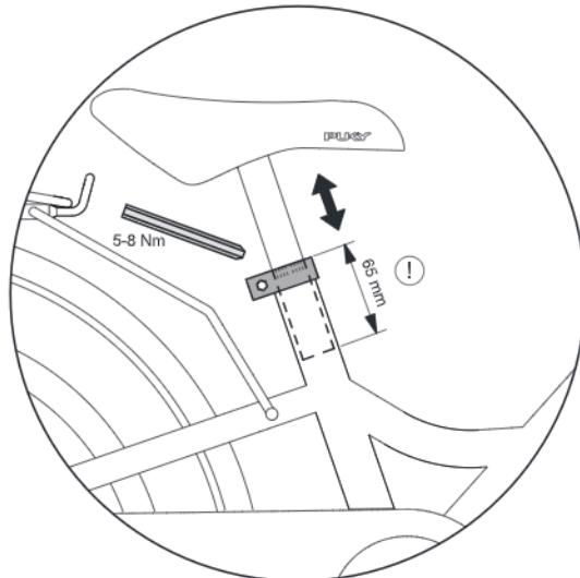
Po odkręceniu zacisku siodełka imbusowym kluczem 5 mm siodełko można wyciągnąć. Wysokość siodełka ustawić tak, aby palce stopy, a najlepiej całe przedstopie, siegały do podłoga, co pozwoli zachować równowagę podczas postoju.
