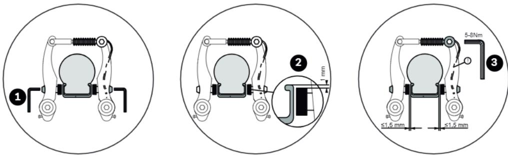
1. Desserrez l'écrou de fixation de la garniture de frein à l'aide d'une clé Allen de 5 mm et remplacez les garnitures de frein
