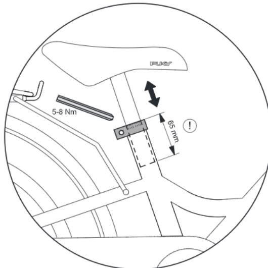
Instelling van de zithoogte: na het losdraaien van de zadelklem met een inbussleutel van 5 mm kan het zadel worden uitgetrokken. Stel de zithoogte zodanig in dat ten minste de tenen, of beter nog de voetzolen in hun geheel de grond bereiken om bij stilstand goed in evenwicht te blijven.
