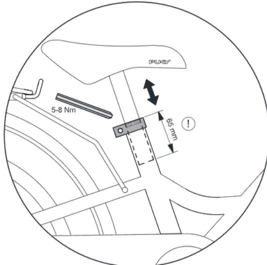
Регулировка высоты сиденья: сиденье можно вытянуть после того, как с помощью торцового шестигранного ключа 5 мм будет ослаблен зажим сиденья. Высоту сиденья необходимо отрегулировать так, чтобы ребёнок мог доставать до земли носком ноги, а еще лучше всей стопой и таким образом сохранять равновесие.
