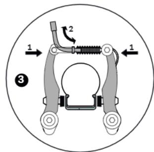
1. Nehmen Sie das lose Ende des Bremszuges und stecken Sie die Endtonne in die vorgesehene Vertiefung am Bremshebel.
