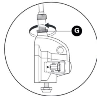
REVOSHIFT de nuevo de 1 a 2 y asegúrese de que la linea roja de la biela está alineada con el final del eje del buje. Si no fuese así, tiene que volver a realizar el ajuste.
