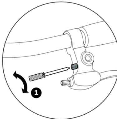
1. El ancho del manillar (distancia palanca de freno - manillar) se puede regular individualmente en el asa con un tornillo. ¡Preste atención a que el freno tiene que surtir efecto antes de que la palanca toque el manillar!
