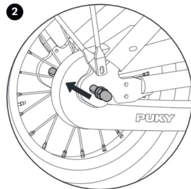
2. Натяжение цепи можно регулировать только путем перемещения заднего колеса в дропаут. Затем снова крепко затяните гайки колеса (Крутящий момент 15 Нм)
