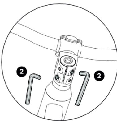
Aanhaalmoment voor het klemmen van de stuurstangen in de vorkbus: 5-6 Nm. Zorg ervoor dat de stuurstangen stevig vastzitten in de vorkbus en niet kan verdraaien.
