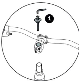
1. Commencez par desserrer et retirer le cache Ahead (Clé Allen de 5 mm).
