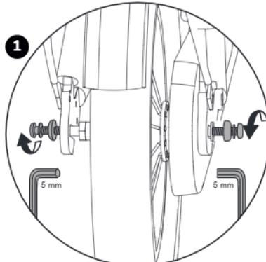
De ketting moet een verticale speling hebben van ongeveer 1,5 cm. De kettingspanning wordt als volgt ingesteld:
