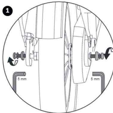
Łańcuch powinien posiadać pionowy luz wynoszący ok. 1,5 cm. Łańcuch napina się w następujący sposób: Rys. 15: Poluzować obie nakrętki tylnego koła
