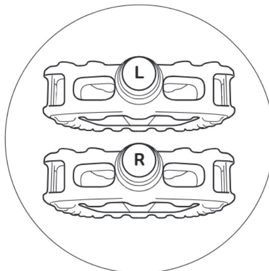
De pedalen zijn aan de voorkant van de schroefas gemaarkeerd met een "R" of "L".
