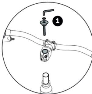
1. Lösen und entnehmen Sie zuerst die Ahead-Kappe (Inbusschlüssel 5mm).
