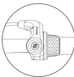
Если в ходе эксплуатации изделия потребуется повторная регулировка, то действуйте следующим образом: Переключите рычаг REVOSHIFT в положение 2. Затем поверните тянутый регулировочный винт (A), чтобы красная линия (D) на шатуне была выровнена с концом (C) оси ступицы.
