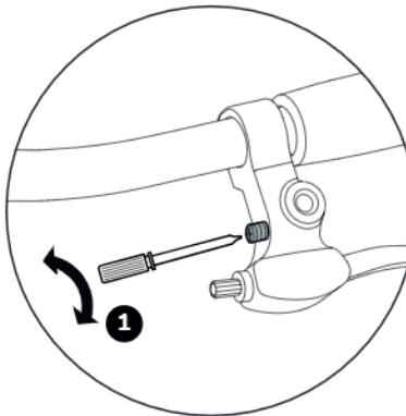
1. Šířku uchopení (odstup brzdové páky od ráfítek) lze
