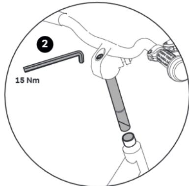
kierownicy przy pomocy imbusowego klucza 6 mm (w modelach YOUKE) lub klucza do śrub SW 13 mm (model STEEL/ STEEL-CLASSIC) (15 Nm).
