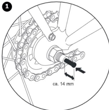
1. Entnehmen Sie den Schaltstift aus dem Polybeutel und stecken diesen bis zum Anschlag mit der schwarzen Feder zuerst in die rechte Seite (in Fahrrichtung) der Hinterachse.
