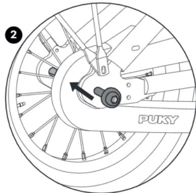
2. Die Kettenspannung kann nun durch Verschieben des Hinterrades im Ausfallende justiert werden. Danach ziehen Sie die Innensechskantschrauben wieder fest (Drehmoment 10 Nm)
