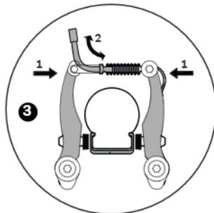
3. Otevření a zavření V-brzdy.
