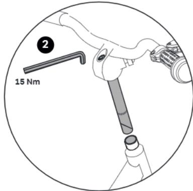
1. Insérer le guidon dans la fourche. Si c'est difficile, desserrez un peu plus la vis du guidon. Insérez le guidon jusqu'à la hauteur souhaitée, positionnez-le en angle droit par rapport à la roue avant et fixez-le en serrant la vis.
