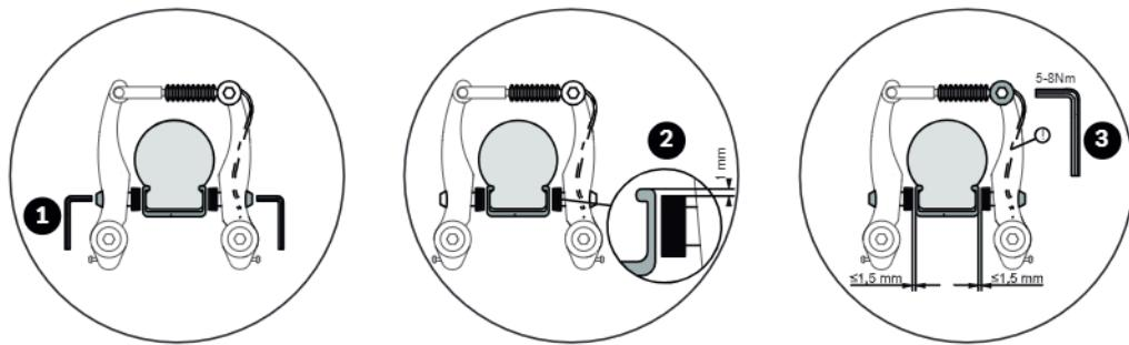
1. Przy pomocy klucza imbusowego 5 mm poluzować nakrętkę mocującą okładzinę hamulcową i wymienić ją. Okładziny hamulcowe powinny wystawać ok.
