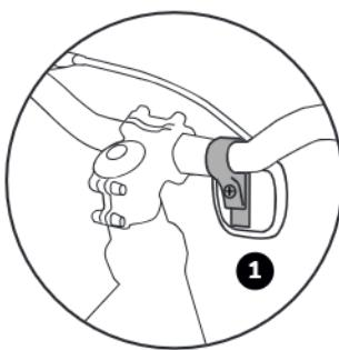
1. Pro montáž na řídítka musí být držák volně namontován na řídítce. Vyrovnajte držák a sešroubujte přední reflektor (bílý) s držákem.
