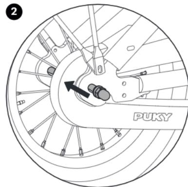
Rys. 16: Napięcie łańcucha można teraz wyregułować przez przesuwanie tylnego koła w haku ramy. Następnie ponownie dokręcić nakrętki tylnego koła (momentem 15 Nm)
