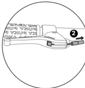
2. Nakonec opatrně zatáhněte za vnější plášť brzdrovýho lanka, aby zapadl koncový doraz na nastavova-
