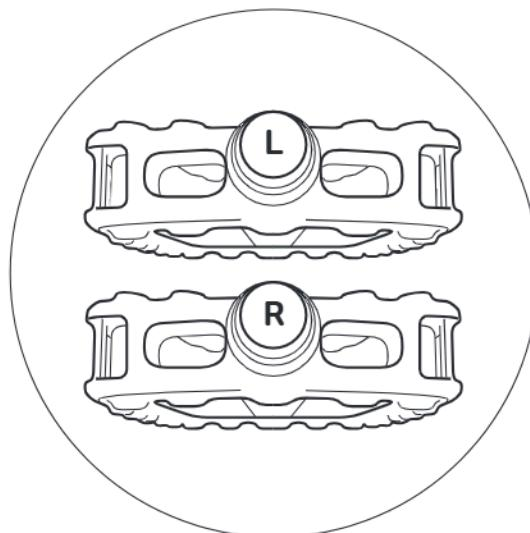
Die Pedale sind an der Stirnfläche der Schraubachse entsprechend mit einem „R“ bzw. „L“ markiert.
