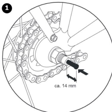
1. Haal de schakelpen uit het plastic zakje en steek deze tot aan de aanslag met de zwarte veer eerst in de rechterzijde (in rijrichting) van de achteras.
