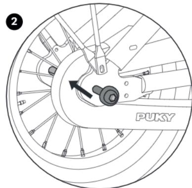
2. Ahora puede ajustar la tensión de la cadena desplazando la ruedas trasera. Después vuelva a apretar las tuercas (par 10 Nm)
