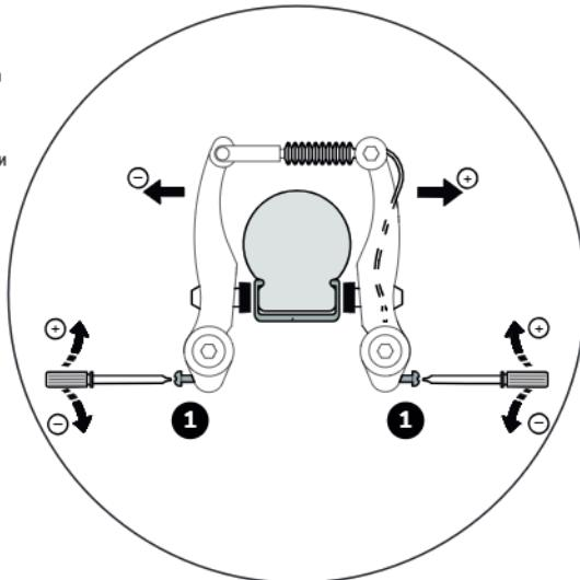
1. Поворачивая регулировочный винт, отрегулируйте скобы тормоза по центру.
