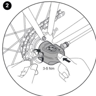
2. in seguito è possibile posizionare la scatola di controllo sull'asse posteriore, fissandola con una chiave a brugola da 5 mm (3-5 Nm). Non sono necessarie ulteriori regolazioni della scatola di controllo.
