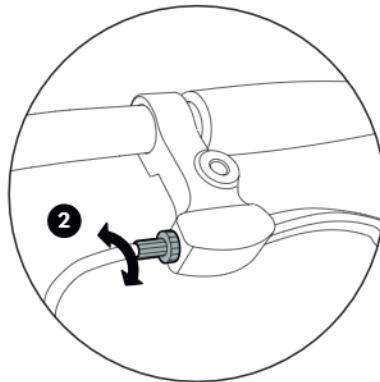
2. Napnutí lze nastavit na brzdové rukojeti pomocí
