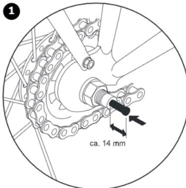
1. Достаньте контактный штифт из пластикового пакета и наденьте его до упора черной пружины сначала на правой стороне задней оси (по направ-
