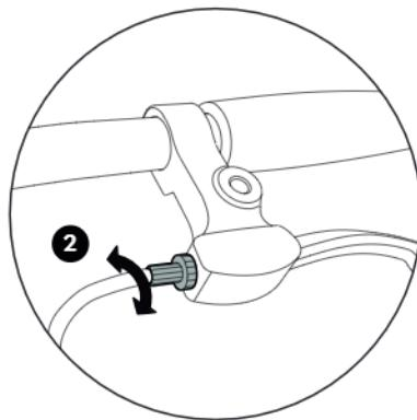
2. La tension du câble peut être réglée à l'aide de la vis moletée sur les leviers de frein.
