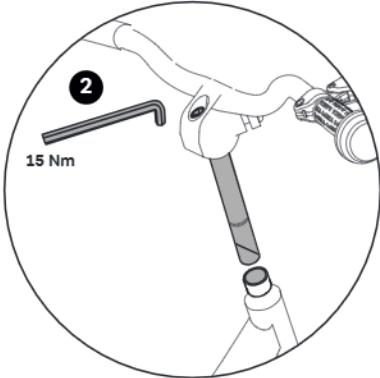
Let daarbij op de markering voor de minimale insteekdiepte van de voorbouwschacht. Bevestig nu het stuurkussen weer op het stuur.
