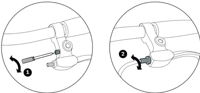
1. De greepwijdte (afstand remhendel - stuur) kan individueel worden aangepast door middel van een schroef op de remhendel. Zorg ervoor dat de remwerkking correct is voordat de hendel het stuur raakt!
