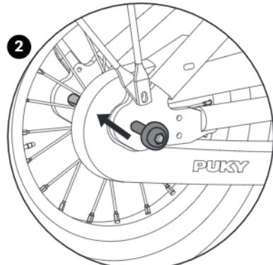
2. De kettingspanning kan alleen worden ingesteld door het achterwiel in de uitloop te verschuiven.
