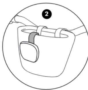
2. Für die Montage am Lenkerkorb muss die Halterung lose über die vordere Kante vom Lenkerkorb gesteckt werden. Richten Sie die Halterung aus und verscreuben Sie den Front-Reflektor (weiß) mit der Halterung
