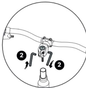
3. Nu kan de voorbouw van de vorkbus worden afgetrokken. Stel vervolgens het stuur in op de gewenste hoogte. Mogelijke standen zijn:
