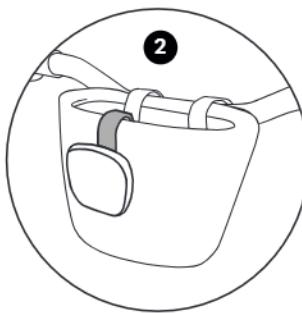
2. Для установки на рулевую корзину крепление следует свободно надеть на передний край рулевой корзины. Выровняйте крепление и привинтите передний отражатель (белый) к креплению.
