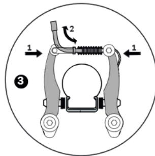
1. Prenez l'extrémité libre du câble de frein et insérez le grain de câble dans le renforcement prévu à cet effet sur le levier de frein
