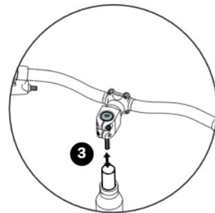
• spacer boven en onder de voorbouw
