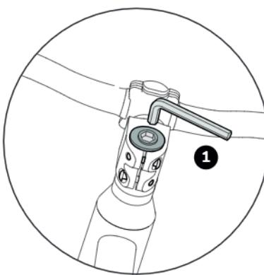
1. Po přestavbě distančních kroužků opět namontujte krytku A-head, řídítka nasámejte rovně ve směru jízdy a správně nastavte vůli ložiska řízení. Přitom použijte nastavovací šroub v krytce A-head.
