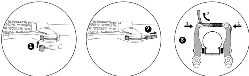
1. prendere l'estremità libera del cavo del freno e inserire la parte terminale nell'apposita cavità sulla maniglia del freno.
