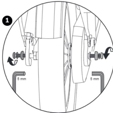
Die Kette sollte ein vertikales Spiel ca. 1,5 cm aufweisen. Die Einstellung der Kettenspannung wird wie folgt vorgenommen:
