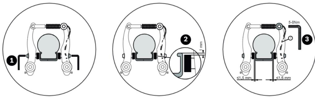
1. Lösen Sie die Befestigungsmutter des Bremsbelags mit Hilfe eines Inbusschlüssels 5 mm und tauschen Sie die Bremsbeläge aus.
