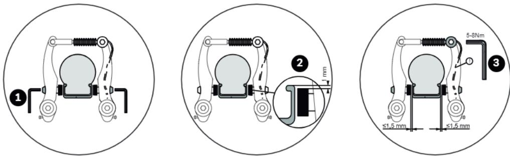
1. allentare il dado di fissaggio della pastiglia con l'aiuto di una chiave a brugola da 5 mm e sostituire le pastiglie.
