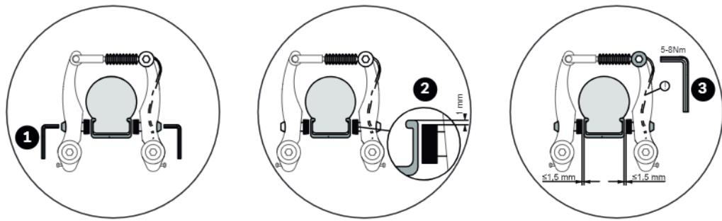
1. Povolte upevnovací matici brzdrových obložení pomocí inbusového klíče 5 mm a vyměňte brzdrová obložení.
