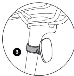
3. Pro montáž na sedlovou trubku musí být držák volně nasunutý na sedlové trubce (včetně gumového kroužku). Vyrovnajte držák a sešroubujte zadní reflektor (červený) s držákem.
