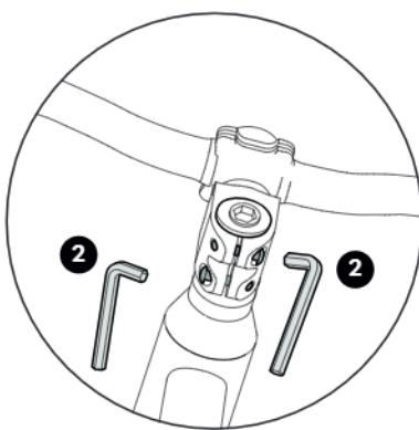
1. Po przełożeniu tulejek dystansowych zamontować kapsel wspornika ahead, ustawić kierownicę prosto do kierunku jazdy i ustawić prawidłowo luźko sterowego. Wykorzystać do tego celu śrubę regulacyjną w kapsle wspornika ahead. Prawidłowe ustawienie: kierownica musi jeszcze pozwalać się
