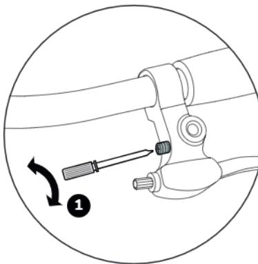
1. L'ouverture des poignées (distance entre le levier de frein et le guidon) peut être réglée individuellement à l'aide de la visser sur le levier de frein. Veuillez noter que le freinage doit s'effectuer avant que le levier de frein ne touche le guidon !
