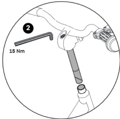
1. Stecken Sie den Lenker in den Gabelschacht. Falls dies nur schwer möglich ist, lösen Sie die Schraube am Lenker noch weiter. Stellen Sie den Lenker auf die gewünschte Höhe ein, richten Sie ihn rechtwinklig zum Vorderrad aus und arretieren Sie ihn.
