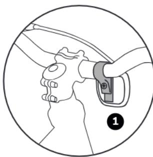
1. Für die Montage am Lenker muss die Halterung lose über den Lenker gesteckt werden. Richten Sie die Halterung aus und verscreuben Sie den Front-Reflektor (weiß) mit der Halterung.
