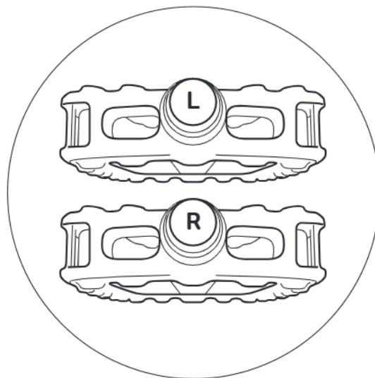
Pedály jsou na čelní ploše šroubové osy odpovídajícím způsobem označeny písmenem „R“ (pravý), příp. „L“ (levý).
