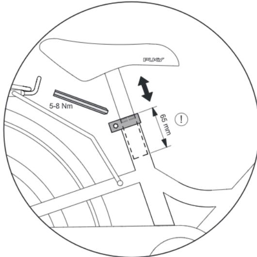
Einstellung der Sitzhöhe: nach Lösen der Sattelklemme mit Hilfe eines Inbusschlüssels 5 mm kann der Sattel herausgezogen werden. Bitte stellen Sie die Sitzhöhe so ein, dass mindestens die Fußspitze, besser noch der ganze Fußballen den Boden erreicht, um im Stand die Gleichgewichtslage zu erreichen.
