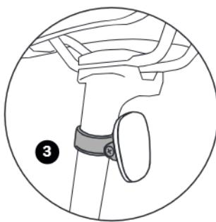
3. Für die Montage an der Sattelstütze muss die Halterung lose über die Sattelstütze (inklusive Gummi-Ring) gesteckt werden. Richten Sie die Halterung aus und verscreuben Sie den hinteren Reflektor (rot) mit der Halterung.
