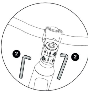
Utahovací moment pro upnutí představce v trubici vidlice: 5–6 Nm. Ujistěte se, že představec je na vidlice nasazený tak, že je zabezpečený proti otvoření.
