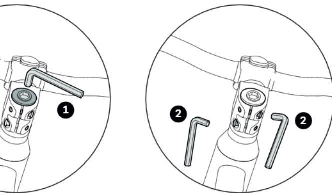
Korrekte Einstellung: der Lenker muss sich noch leicht drehen lassen, ohne dass das Steuerlager Spiel aufweist.
