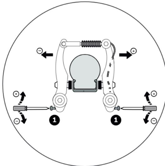
1. Durch Drehen der Einstellschraube justieren Sie nun die Bremsarme mittig aus.
