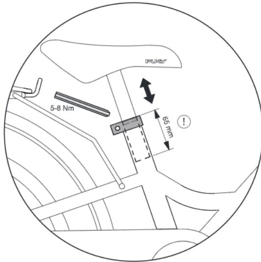
Indstilling af siddehøjde: Når sadelklemmen er løsnet med en 5 mm unbrakonegle, kan sadlen trækkes ud. Indstil siddehøjden således, at id et mindste tåspids- serne, eller endnu bedre hele foden når jorden, så man kan holde balancen når man holder stille.
