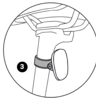
3. Para montar en la tija debe insertar el soporte suelto sobre la tija (incluyendo la anilla de goma). Alinee el soporte y atornille el reflector dorsal (rojo) con el soporte.
