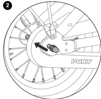
2. Ahora puede ajustar la tensión de la cadena desplazando la ruedas trasera. Después vuelva a apretar las tuercas (par 15 Nm)
