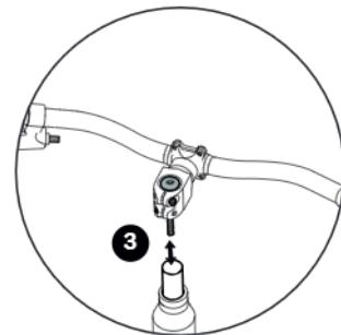
• Spacer über dem Vorbau und darunter (mittlere Lenkerposition)
