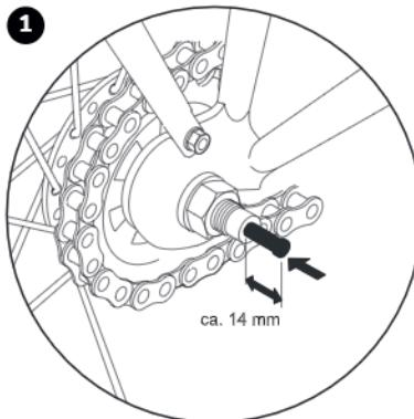
1. Extraiga la clavija de la bolsita de plástico e introduzcalo hasta el tope con el resorte negro primero en el lateral derecho del eje trasero (en el sentido de la marcha).
