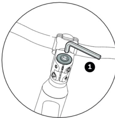
1. dopo l'ampliamento del distanziatore, rimontare il cappuccio Ahead, orientare il manubrio nella direzione di guida e regolare correttamente il gioco del cuscinetto. Per farlo, utilizzare la vite di regolazione nel cappuccio Ahead.
