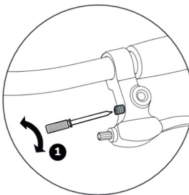
1. la larghezza della presa (distanza tra leva del freno e manubrio) può essere regolata individualmente mediante una vite sulla maniglia del freno. Accertarsi che il freno venga azionato prima che la leva del freno tocchi il manubrio!
