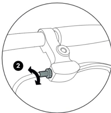
2. Натяжение можно регулировать винтом с рифленой головкой на рукоятке тормоза. Тормоз отрегулирован правильно, если тормозные накладки отстоят от обода примерно на 1,5 мм.
