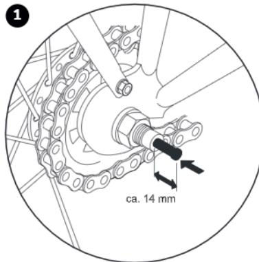
1. Z polietilenowego worka wyjąć trzpień łączący i wełożyć go do oporu czarną sprężyną do przodu z prawej strony (patrząc w kierunku jazdy) tylnej osi.
