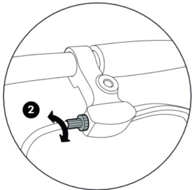
2. Die Zugspannung kann mittels der Rändelschraube am Bremsgriff eingestellt werden.
