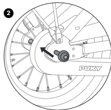
перемещения заднего колеса в дропаут. Затем снова крепко затяните гайки колеса (Крутящий момент 10 Нм)
