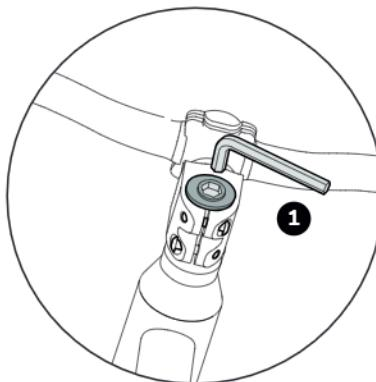
1. Après avoir déplacé les distanceurs, remontez le cache Ahead, positionnez le guidon dans la direction de conduite. Pour cela, utilisez la vis de réglage qui se trouve dans le cache Ahead.
