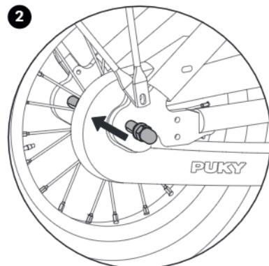
2. Napnuti řetězu lze nyní nastavit posunutím zadního kola v upevnění pastorku. Potom kolové matici opět utáhněte (utahovací moment 15 Nm)
