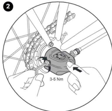
2. Vous pouvez ensuite installer la boîte de vitesses sur l'essieu arrière et la serrer à l'aide d'une clé Allen de 5 mm (3-5 Nm). La boîte de vitesses ne nécessite aucun autre réglage.
