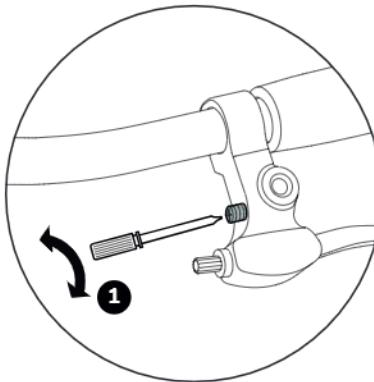
1. Die Griffweite (Abstand Bremshebel-Lenker) kann mittels einer Kreuzschlitz-Schraube am Bremsgriff individuell eingestellt werden. Bitte achten Sie darauf, dass die Bremswirkung einsetzen muss, bevor der Bremshebel den Lenker berührt!
