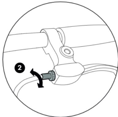
2. La tensión del cable se puede regular con el tornillo moletado en las asas de freno. La tensión del cable del freno está correctamente ajustada cuando la zapata está respectivamente aprox. a 1,5 mm de la llanta.
