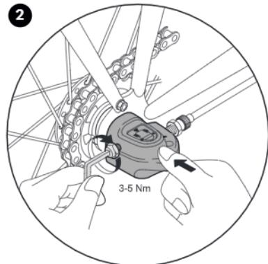
2. Anschließend können Sie die Schaltbox auf die Hinterachse aufsetzen und diese mit einem 5 mm Inbusschlüssel festziehen (3-5 Nm). Weitere Einstellungen an der Schaltbox sind im Neuzustand nicht notwendig.
