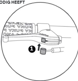
1. Neem het losse uiteinde van de remkabel en steek het tonnetje in de hiervoor bestemde uitsparing op de remgreep
