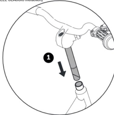
1. Steek het stuur in de vorkbus . Als dit moeilijk gaat, draait u de stuurschroef nog wat losser. Stel het stuur in op de gewenste hoogte, zorg dat het loodrecht op het voorwiel staat uitgelijnd en zet het vast door de bout van de voorbouw aan te draaien.
