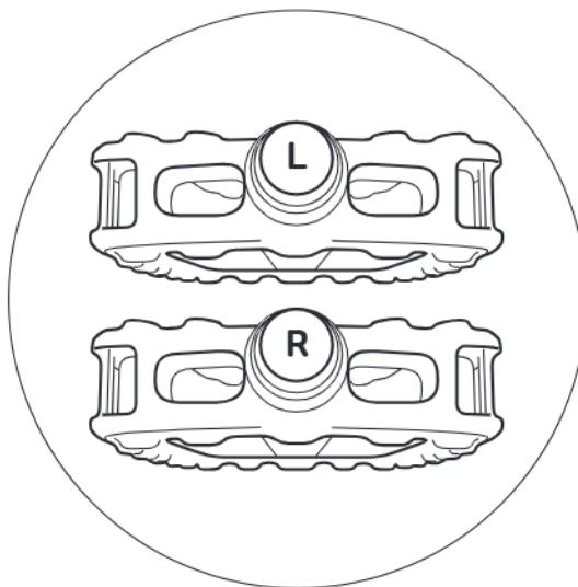
Les pédales sont respectivement pourvues d'un « R » et d'un « L » sur la surface frontale de l'axe de vissage.
