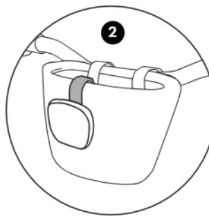
2. Para montar en la cesta debe colocar el soporte suelto sobre el borde delantero de la cesta. Alinee el soporte y atornille el reflector frontal (blanco) con el soporte.
