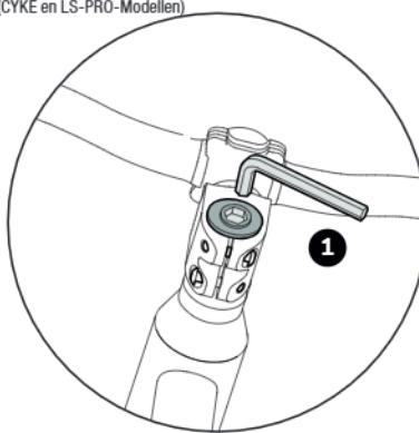
1. Na aanpassing van de spacers plaatst u de Ahead-kap weer terug, lijnt u het stuur recht in de richting uit en stelt u de spelting van de stuurlijn correct in. Gebruik hiervoor de stelschroef in de Ahead-kap.
