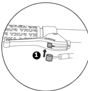
1. Sæt nu den løse ende af bremsekablet i den dertil beregnede fordybning i bremsehåndtaget.
