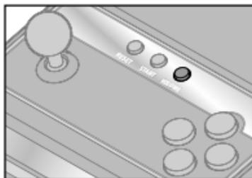
Die Lautstärke ist bei jedem Einschalten bzw. Reset standardmäßig auf mittlerer Stufe eingestellt. Sie können die Lautstärke durch wiederholtes Drücken der Taste **VOLUME** wie folgt verändern:
