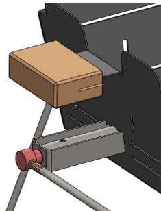
Anschlussklemme zusammendrücken und einhängen (Abb. 7)
