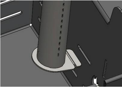
Dickes Brennerrohr in Grill einhängen. (Abb. 2)
