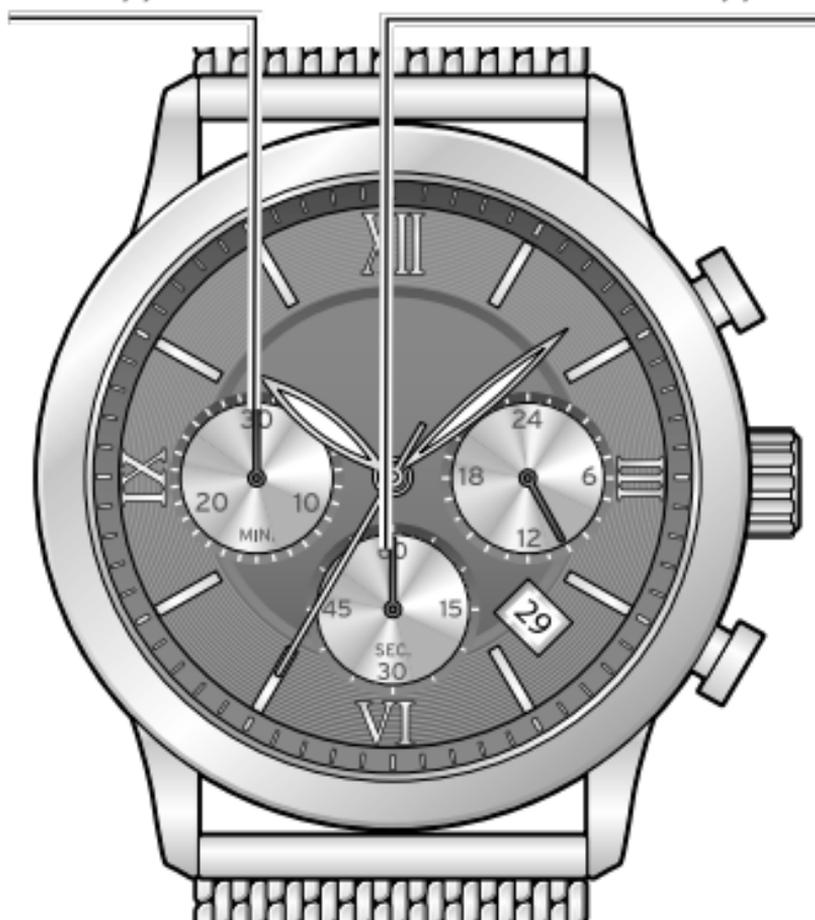
Die Stoppuhrfunktion wird durch die kleinen Sekunden- und Minutenzeiger angezeigt.
