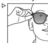
Um die Lautstärke zu erhöhen, drücken Sie kurz die Bedientaste des **rechten** Brillenbügels **3x**.
