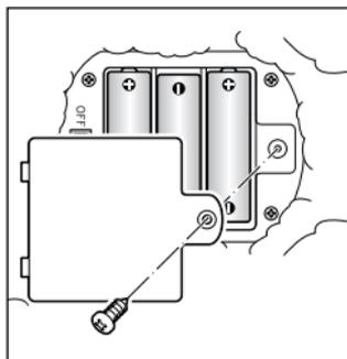
1. Lösen Sie die Schraube am Batteriefachdeckel und nehmen Sie den Deckel ab.
