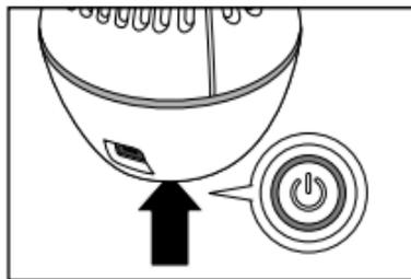
2. **Um das Gerät einzuschalten**, halten Sie den Ein-/Ausschalter ca. 3 Sekunden gedrückt. Die Kontrollleuchte im Ein-/Aus-Schalter leuchtet grün. Der Aufsatz dreht sich mit normaler Geschwindigkeit (Geschwindigkeitstufe 1).
