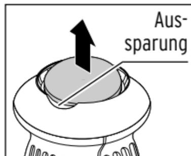
4. **Um den Aufsatz abzunehmen**, greifen Sie auf beiden Seiten in die Aussparung und ziehen Sie den Aufsatz nach oben ab.
