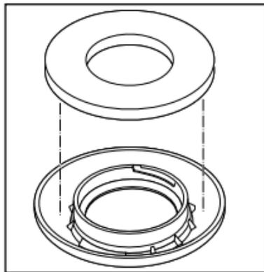
2. Drehen Sie die Abdeckung um und stecken Sie einen Schutzfilter in die Aufnahme.
