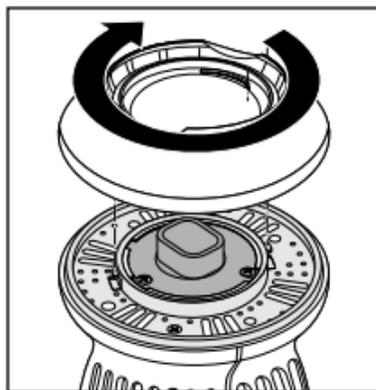
3. Drehen Sie die Abdeckung wieder um und drehen Sie sie im Uhrzeigersinn bis zum Anschlag fest.
