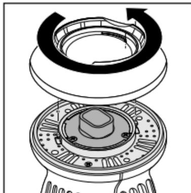
1. Drehen Sie die Abdeckung gegen den Uhrzeigersinn bis zum Anschlag und heben Sie sie nach oben ab.
