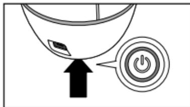
4. **Um das Gerät auszuschalten**, halten Sie den Ein-/Aus-Schalter ca. 3 Sekunden gedrückt. Die Kontrollleuchte auf der Unterseite erlischt.
