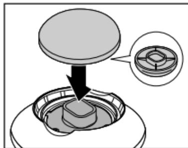
3. **Um den Aufsatz aufzusetzen**, stecken Sie den Aufsatz wie abgebildet auf das Gerät und drücken Sie ihn bis zum Anschlag herunter.
