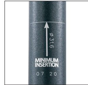
Abb. 35 Maximale Auszugshöhe beachten!
