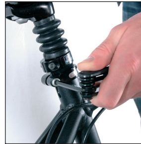
Abb. 34 Einstellung der Sattelhöhe
