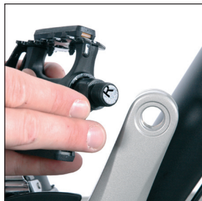
Abb. 36 Rechtes Pedal an rechten Kurbelarm montieren
