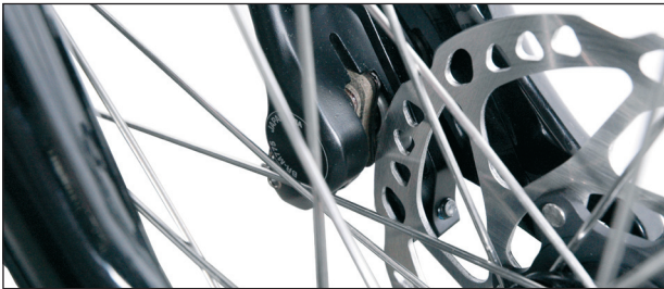
Abb. 11 Bremsscheibe mittig einführen
