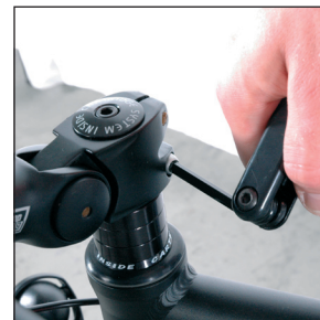
Abb. 26 Klemmschraube des Vorbaus am Gabelschaft
