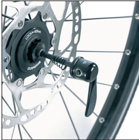
Abb. 3 Schnellspannhebel links in Fahrtrichtung montieren
