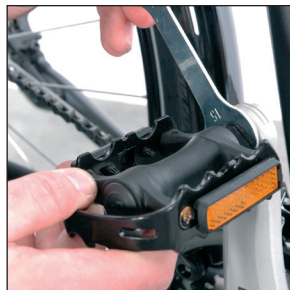
Abb. 37 Rechtes Pedal im Uhrzeigersinn festziehen
