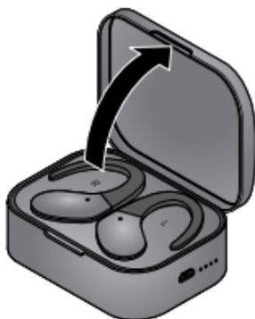
1. Um die Ladebox zu öffnen, greifen Sie in den Spalt und klappen Sie den Deckel hoch, bis er einrastet.
