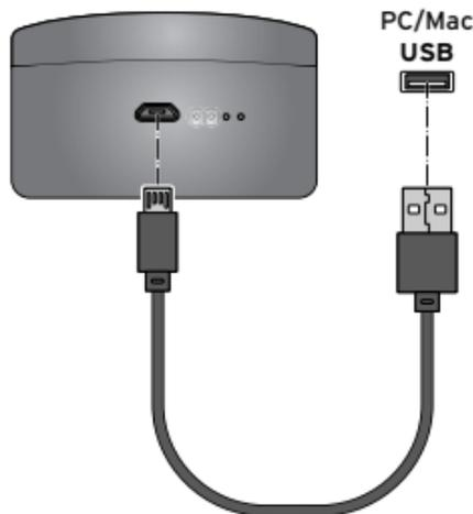
4. Schließen Sie die Ladebox mit dem beiliegenden Ladekabel an einen USB-Anschluss am Computer oder einen Netzadapter mit USB-Anschluss (nicht im Lieferumfang) an.
