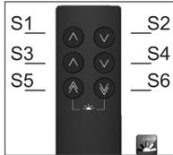
A kézi vezérlő gombjai irányítják az ágy pozicionálását. **(S1)** és **(S2)** emelje fel és engedje le a hátsó beállítómotort **(S3)** és **(S4)** emelje fel és engedje le a
