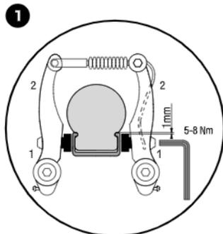
Hamulec tego pojazdu został zamontowany i wyregulowany przez PUKY. Upewnij się, że obydwie okładziny hamulcowe są względem siebie równoległe i właściwie ustawione względem obręczy koła. Muszą one znajdować się ok. 1 mm poniżej górnej krawędzi obręczy koła. Jeżeli ustawienie nie będzie prawidłowe, to należy poluzować śrubę mocującą okładzinę hamulcową (1) i wykonać regulację zgodnie z powyższym opisem. W tym celu pociągnąć za dźwignię hamulca i ponownie dokręcić śrubę mocującą (5-8 Nm).
