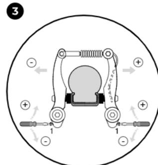
Ruotando la vite di regolazione, si correggono ora le braccia del freno centralmente. È necessario un cacciavite a croce separato.
