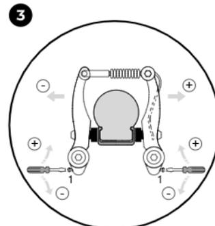
Door de instelschroef te verdraaien, lijnt u de remarmen naar het midden toe uit. Hiervoor is een aparte kruiskopschroevendraaier nodig.
