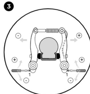
Durch Drehen der Einstellschraube (1), justieren Sie nun die Bremsarme mittig aus. Sie benötigen einen gesonderten Kreuzschlitzschraubendreher.
