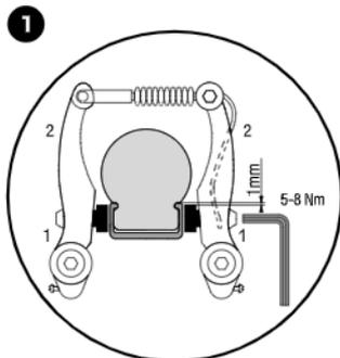
Le frein de ce véhicule a été pré-monté et réglé par PUKY. Assurez-vous que les deux garnitures de frein soient parallèles et soient correctement positionnées au niveau de la jante. Elles doivent se trouver à une distance de 1 mm en dessous du bord supérieur de la jante. Si le réglage n'est pas correct, desserrez l'écrou de fixation de la garniture de frein (1) et positionnez la garniture comme indiqué ci-dessus. Pour cela, tirez le levier de frein et resserrez l'écrou de fixation (5-8 Nm).
