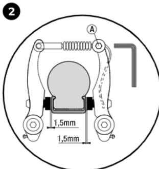
Натяжение тормозного троса на фиксирующей гайке (А) должно быть отрегулировано таким образом, чтобы тормозные накладки отстояли от обода примерно на 1,5 мм.
