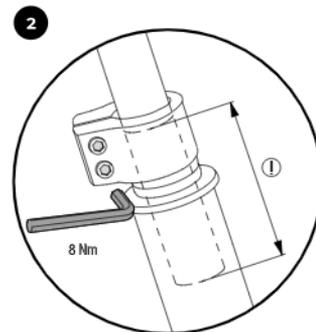
Draai de schroef vast. Let daarbij op de markering (!) voor de minimale insteekdiepte!
