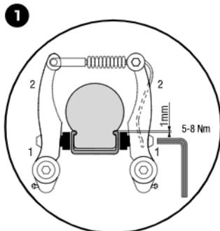
Bromsen i detta fordon har förmonterats och ställts in av PUKY. Kontrollera att båda bromsbelägen står parallellt mot varandra och är korrekt inriktade på fälgen. Bromsbelägen ska befinna sig på ett avstånd av ca 1 mm under fälgens övre kant. Om inställningen inte är korrekt, lossar du fastmuttern till bromsbeläget (1) och justerar den enligt beskrivningen ovan. Tryck ihop bromsarmarna (2) med handen och dra åt fastmuttern igen (5-8Nm).
