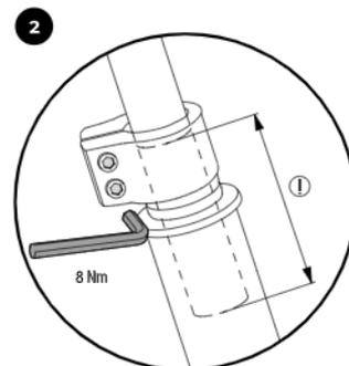
Dokręcić śrubę. Przestrzegać oznakowania minimalnej głębokości wetknięcia trzpienia!
