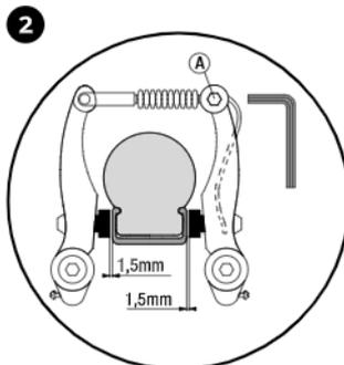
Die Spannung des Bremszuges ist an der Verankerungsmutter (A) so eingestellt, dass der Bremsbelag jeweils ca. 1,5 mm von der Felge entfernt ist.
