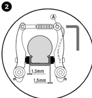
De spanning van de remkabel wordt zodanig met de borgmoer (A) ingesteld, dat de remblokjes ca. 1,5 mm van de velg af staan.
