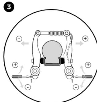
En tournant la vis de réglage, vous pouvez maintenant centrer les étriers de frein. Un tournevis cruciforme est nécessaire pour cela.
