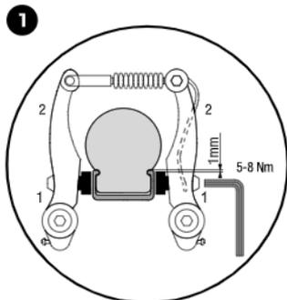
De rem op dit voertuig is al vooraf gemonteerd en afgesteld door Puky. Zorg ervoor dat beide remblokken parallel staan en correct zijn uitgelijnd op de velg. Ze moeten op een afstand van ca. 1 mm onder de bovenkant van de velg staan. Als de instelling niet correct is, draait u de bevestigingsmoer van het remblok (1) los en stelt u het geheel in zoals hierboven beschreven. Trek aan de remhendel en draai de bevestigingsmoer weer vast (5-8 Nm).
