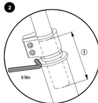
затяните винт. При этом следите за меткой минимальной глубины посадки!
