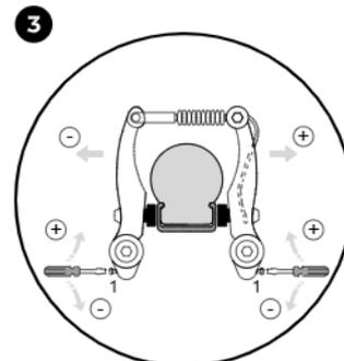
Girando el tornillo de ajuste centra los brazos del freno. Necesita un destornillador de estrella aparte.
