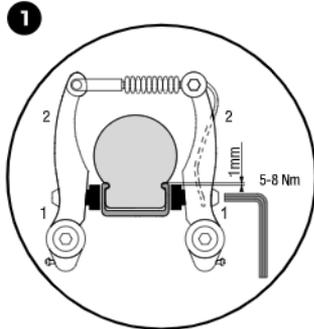
Tähän pyörään PUKY on jo asentanut ja säätänyt jarrun valmiiksi. Varmista, että molemmat jarrupalat ovat minnekkäin toisiinsa nähden ja oikein vanteeseen suunnattuna. Ei niiden tulee olla noin 1 millimetrin etäisyydellä vanteen yläreunan alapuolella. Jos säätö ei ole oikein, löysää jarrupalan kiinnitysmutteria (1) ja säädä kuten edellä kuvattiin. Paina jarruvarsia (2) käsin yhteen ja kiristä kiinnitysmutteri uudelleen (5–8 Nm).
