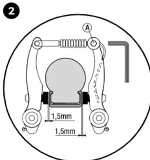
La tensione del cavo del freno è regolata al dado di fissaggio (A) in modo tale che la guarnizione del freno si trovi a una distanza di rispettivamente ca. 1,5 mm.
