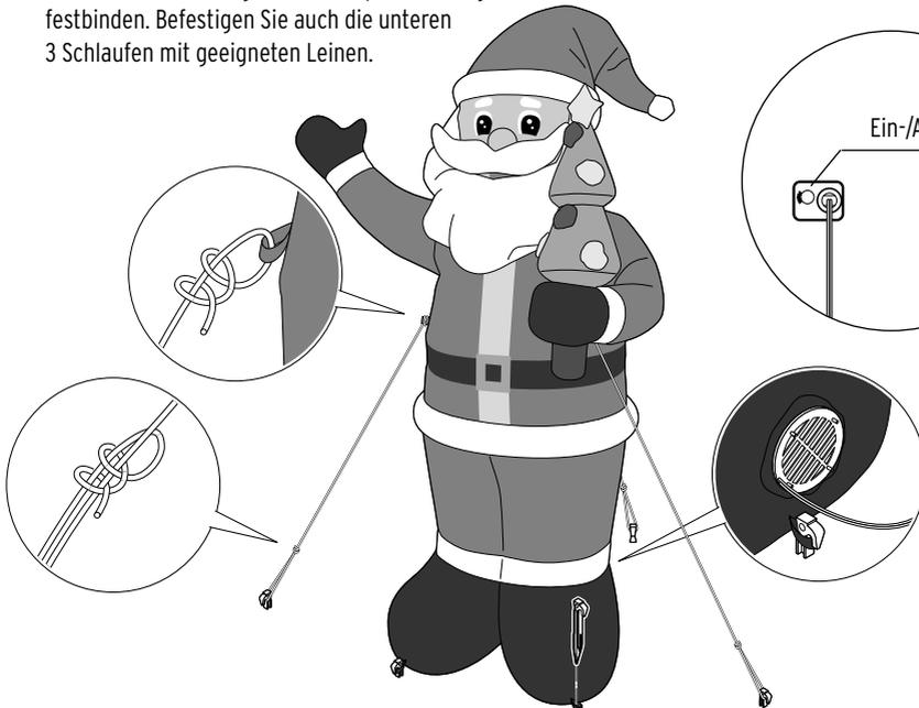
Die Pumpe ist auf Dauerbetrieb ausgelegt. Die Hülle ist nicht komplett luftdicht, sie kann durch die zugeführte Luft nicht zum Bersten gebracht werden.
