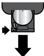
1. Drücken Sie die Arretierung in Pfeilrichtung und ziehen Sie die Batteriehalterung heraus.
