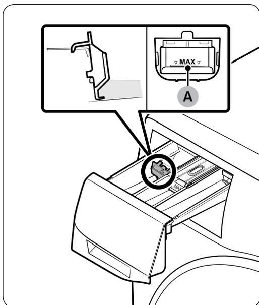
Setzen Sie zunächst den Flüssigwaschmitteleinsatz in das **II Hauptwaschmittelfach** ein. Füllen Sie anschließend Flüssigwaschmittel in das Fach. Überschreiten Sie dabei jedoch nicht die **maximale Einfüllhöhe (A)**.
