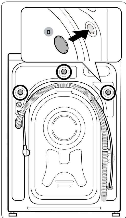
3. Setzen Sie die **Verschlusskappen (B)** in die Öffnungen ein (in der Abbildung mit einem Kreis markiert).
