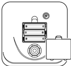
Setzen Sie die Batterien wie im Batteriefach abgebildet ein. Achten Sie dabei auf die korrekte Polarität (+ / -).
