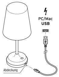
Schließen Sie die Leuchte wie abgebildet mit dem mitgelieferten USB-Ladekabel an einen USB-Anschluss Ihres Computers oder eines Netzadapters mit USB-Anschluss (nicht im Lieferumfang enthalten) an. Der Ladevorgang startet automatisch. Die Kontroll-Leuchte leuchtet rot. Laden Sie den Akku solange, bis die Kontroll-Leuchte von rot zu grün wechselt.
