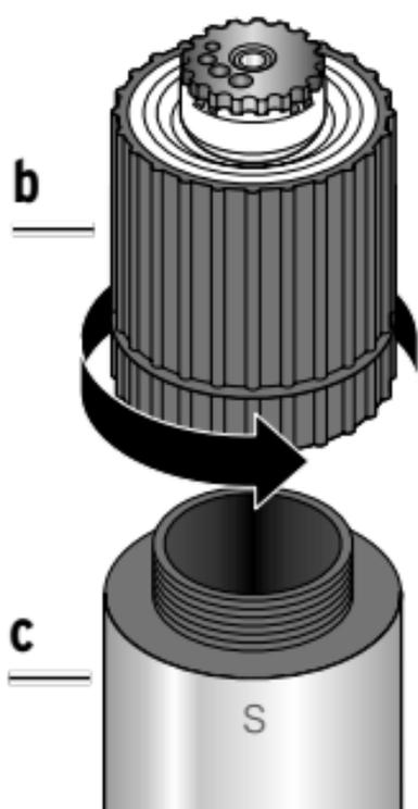
2. Schrauben Sie den schmalen, unteren Ring von Teil **b** gegen den Uhrzeigersinn von Teil **c** ab.
